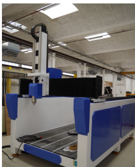
IUT de Béthune Imprimante 3D béton
